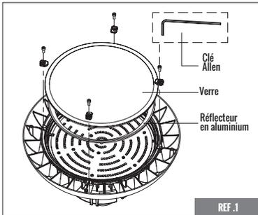
Placez l'appareil à l'envers et utilisez une clé Allen pour desserrer les vis et les clips qui maintiennent le couvercle de la lentille en verre en place. Retirez le couvercle en verre et le réflecteur en aluminium.
