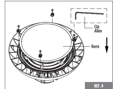
Fixez le couvercle en verre à l'appareil en utilisant la clé Allen et les vis. Serrez-le.
